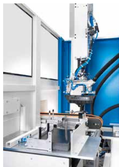
Kompakte Produktionszelle: In der Schutzeinhausung der Spritzgießmaschine CX 300 sind die Logistik für die Bereitstellung des Organoblechs, Waage und Förderband integriert (© KraussMaffei)
