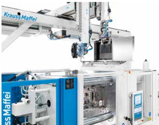
Parallele Prozessschritte: Mit zwei Linearrobotern auf einer gemeinsamen Z-Achse sind die Entnahme des Bauteils und das Einlegen des Organoblechs voneinander entkoppelt (© KraussMaffei)
