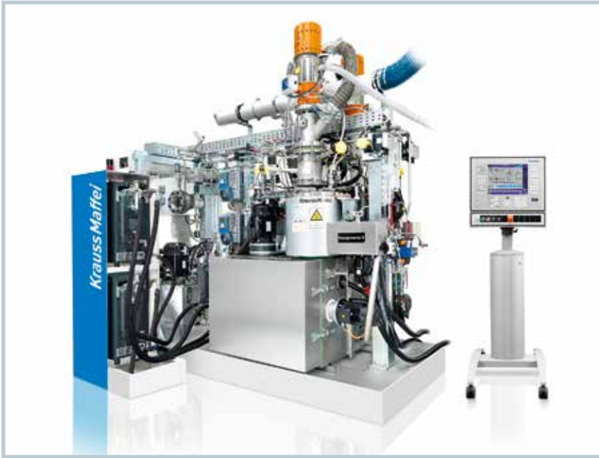
Bild 2. Die neue Dosieranlage RimStar 8/8 T-RTM erlaubt ein automatisiertes Aufschmelzen der Caprolactam-Komponenten (© KraussMaffei)
