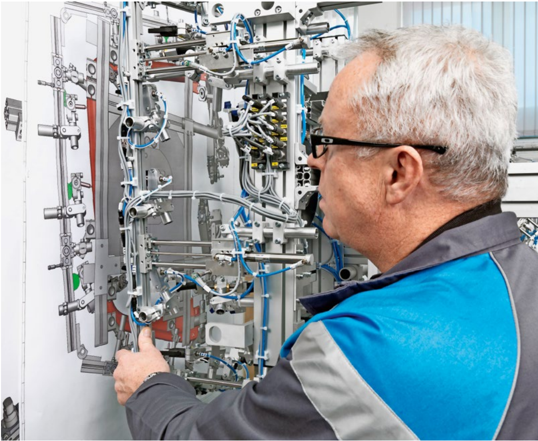
Neben dem modularen Greiferbau aus Standardkomponenten bietet Krauss Maffei Automation auch die maßgeschneiderte Engineered-Variante. Foto: Krauss Maffei
