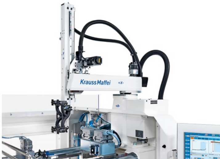
Leichtgewicht: Ein 3D-gedruckter Greifer unterstützte den Servoangusspicker SPX 10 der neuen vollelektrischen PX 120-180 auf der K 2016.
