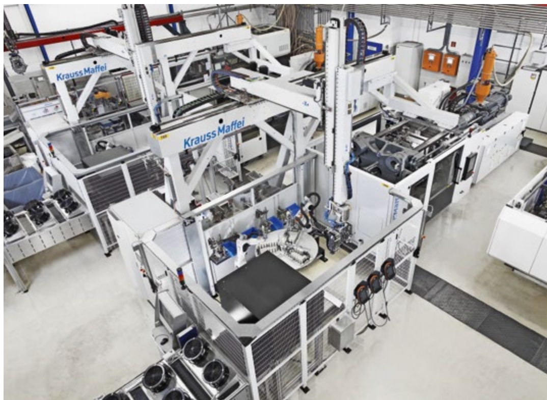
Automatisierung platzsparend integriert: Mit der neuen GX 450/4300 produziert Polytec am Standort Lohne Ölwannen und erreichte über 25 % Effizienzsteigerung. Foto: Krauss Maffei
